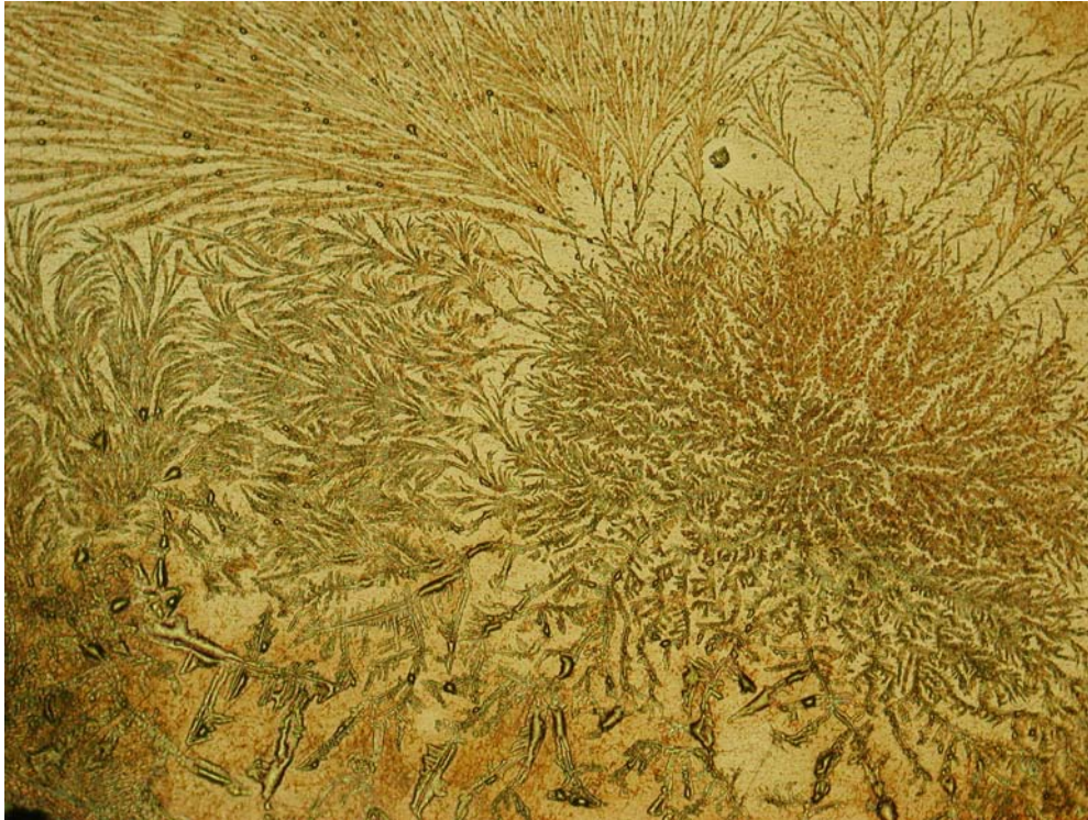
Scheingefüge, Ätzfehler mit V2A Beize
