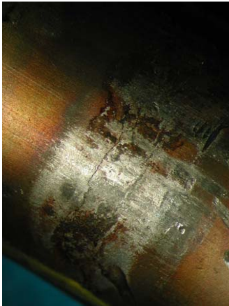
Spannungsrißkorrosion an einer Rohreinspannung , Werkstoff 1.4571
