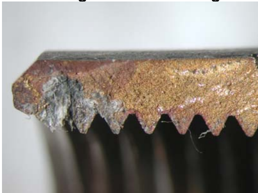
Rot verfärbt Bruchfläche
